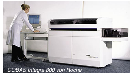
COBAS Integra 800 von Roche Trotz Outsourcing von Managementleistungen sollte das Routinelabor vor Ort bleiben, um schnelle Diagnostik zu gewährleisten. Analysengeräte der dritten Generation machen das dank geringer Personalbindung und großem Methodenspektrum möglich.
